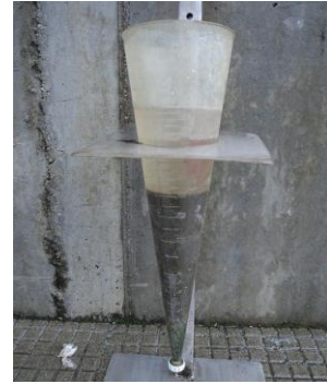
Foto 2. Aspecto do V30 o día 16/10/13. Obsérvase unha boa decantación do fango e un sobrenadante claro.
